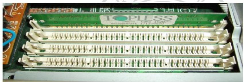
Slika: 30-pinski FPM DRAM SIMM memorijski slotovi na jednoj matičnoj ploči
