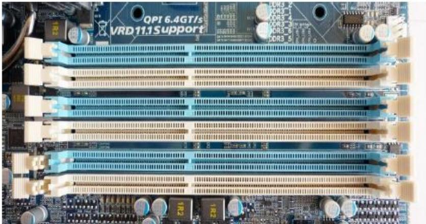
Slika: 240-pinski DDR3 DIMM memorijski slotovi na jednoj matičnoj ploči
