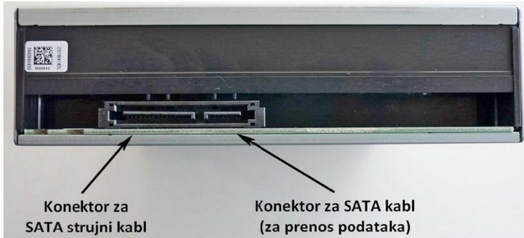
**SATA** konektor – služi za povezivanje **SATA** hard diskova i optičkih uređaja sa računarcem. Budući da je reč o serijskom prenosu podataka, konektor je mnogo uži u odnosu na **PATA**, i ima dobro poznat oblik slova „L“
