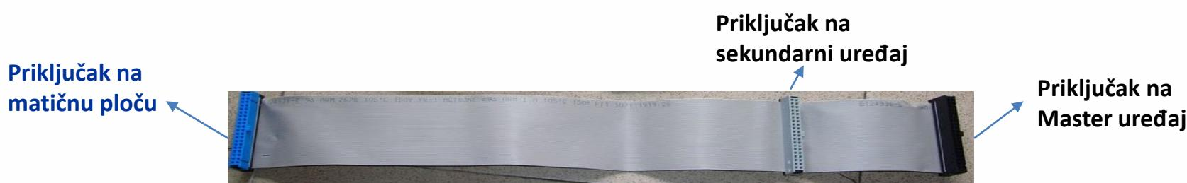
Slika: Kao što se može videti, većina ATA kabla (donji kabl) ima tri priključka, što omogućava priključenje do dva ATA uređaja na jedan ATA priključak na matičnoj ploči. Plavi (ili ponekad zeleni) priključak (sleva) se priključuje na matičnu ploču. Crni priključak (zdesna) je rezervisan za master uređaj, a sivi (u sredini, pored crnog priključka) za slave uređaj. Takođe se primećuje da je sivi priključak mnogo bliži crnom priključku, nego plavom.
