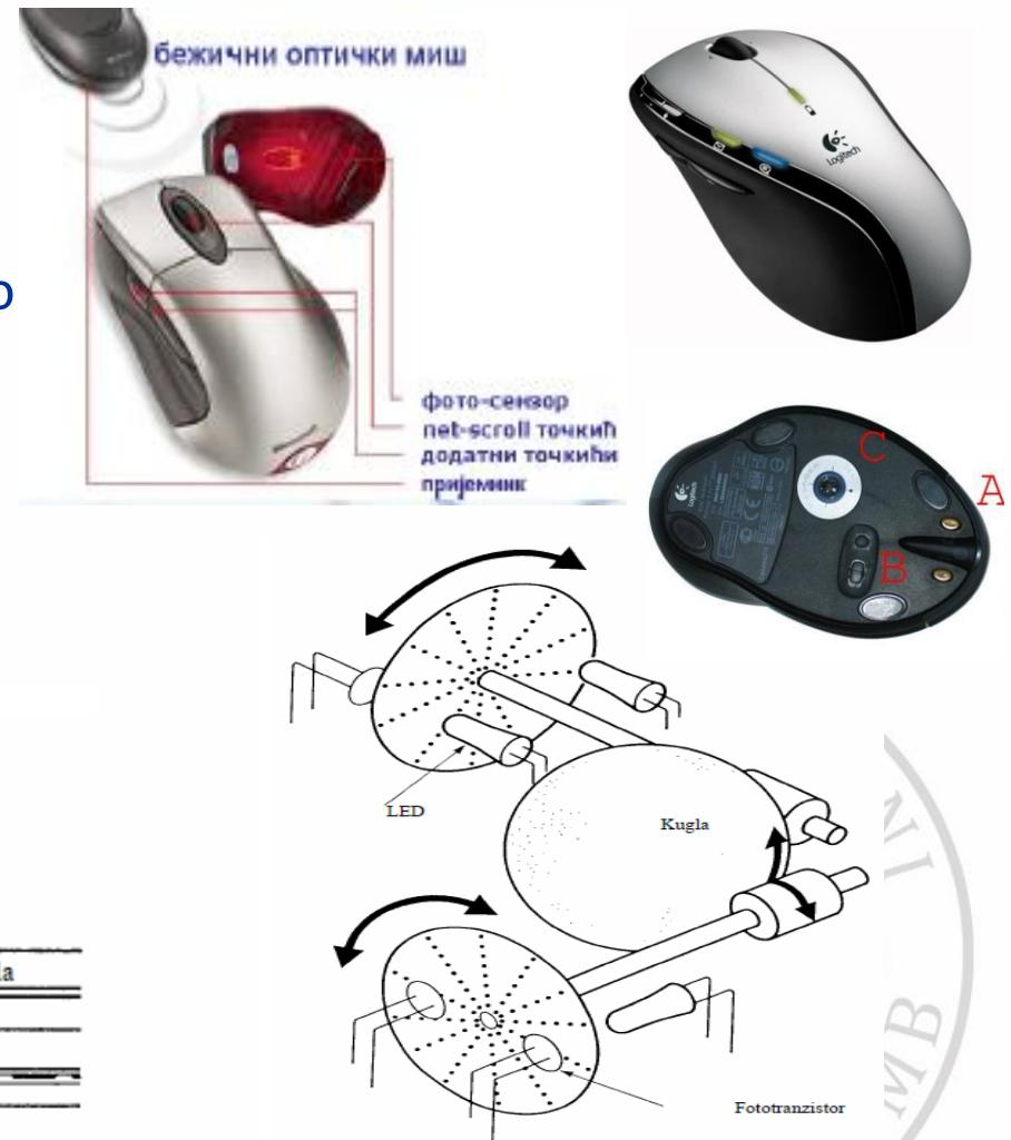
Kugla i osovine sa optičkim prekidačem.
