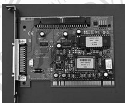
Slika 7.2 Tipična 32-bitna *PCI* kartica za *SCSI* adapter
