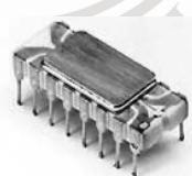
Slika 6.13 Izgled kućišta procesora *Intel* 4004
