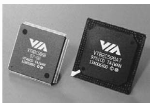
Slika 7.5 Čipset: severni i južni most
