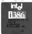
Slika 6.14 Izgled kućišta procesora *Intel* 80386
