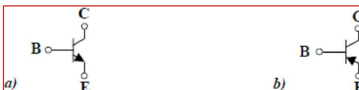
Slika 21. - šematski simbol bipolarnog tranzistora za tipove: a) npn; b) pnp
