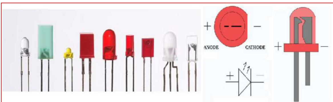
Slika 18. - različiti oblici led dioda i šematski simbol
